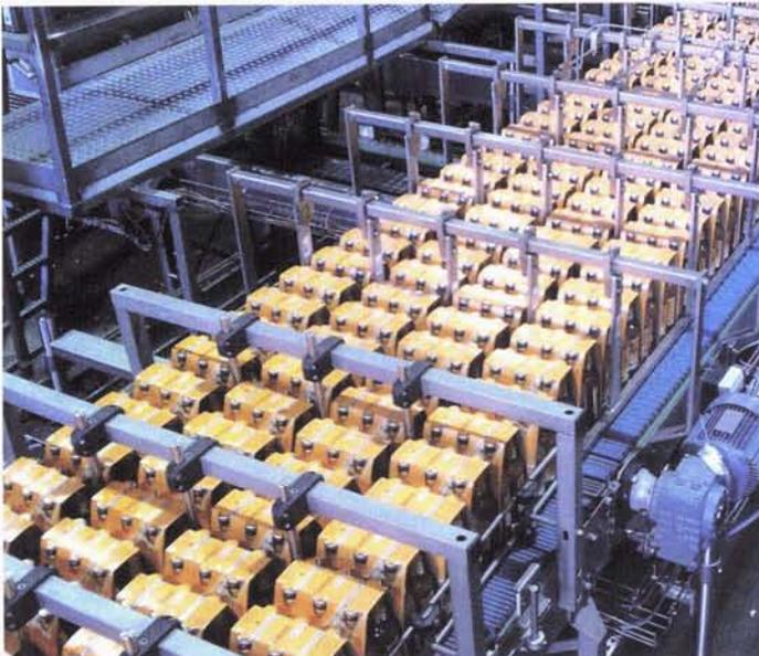
Vierbahnig werden die 6er-Packs aufgereiht, bevor sie in die Maschine einfahren.
