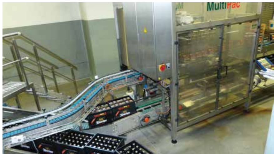
Der Einpacker „MultiPac“ setzt bei jedem Hub acht Six-Packs (0,33 Liter) in zwei Kisten, bevor diese zum Palettierer fahren.
