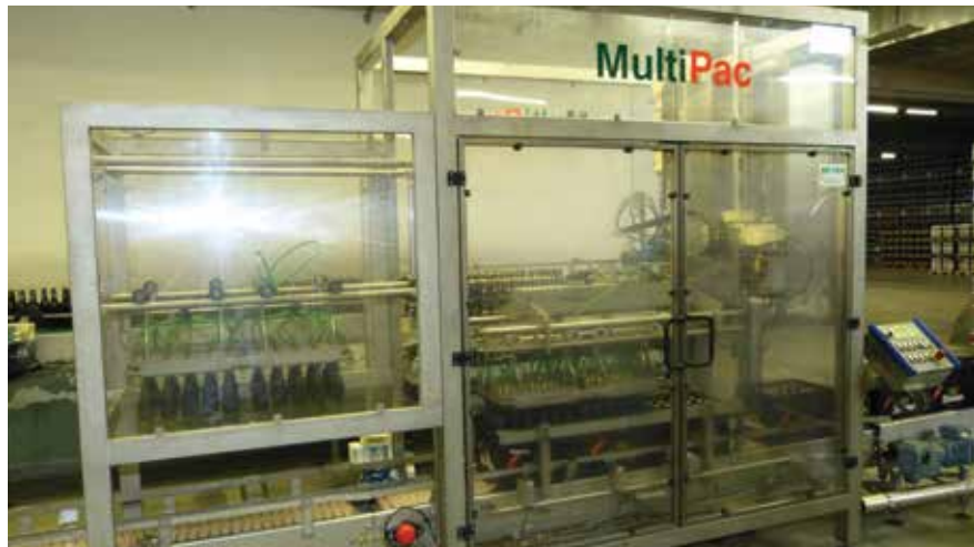
Die Auspackmaschine „Beyer MultiPac“ hebt jeweils die Flaschen von zwei Kisten heraus.
