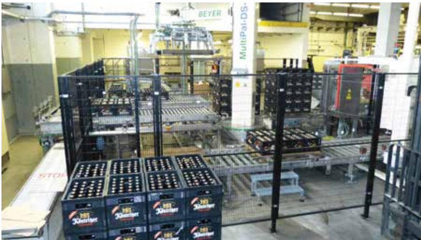
Der neue Beyer-Säulenpalettierer „MultiPal“ entpalettiert die Vollgut-Paletten. Gleichzeitig nimmt er die nun mit Six-Packs bestückten Kisten und palettiert diese.
