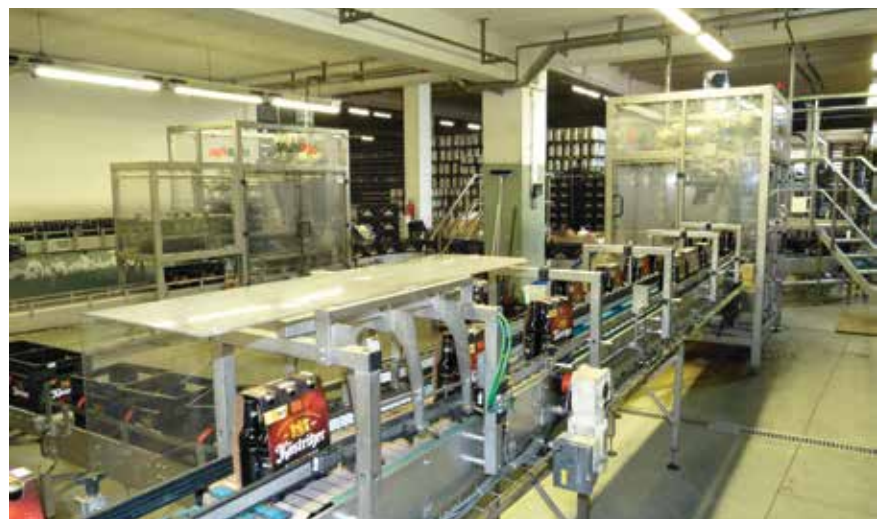
Der Einpacker „MultiPac“ im Vordergrund setzte je acht Six-Packs (0,33 Liter) in zwei Kisten, im Hintergrund der Auspacker, der bei jedem Hub zwei Kisten leert.
