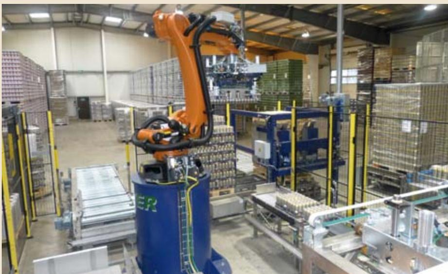
Palettierroboter mit 180 kg Tragkraft, fünf Achsen und Hochgeschwindigkeits-Gabelgreifer
