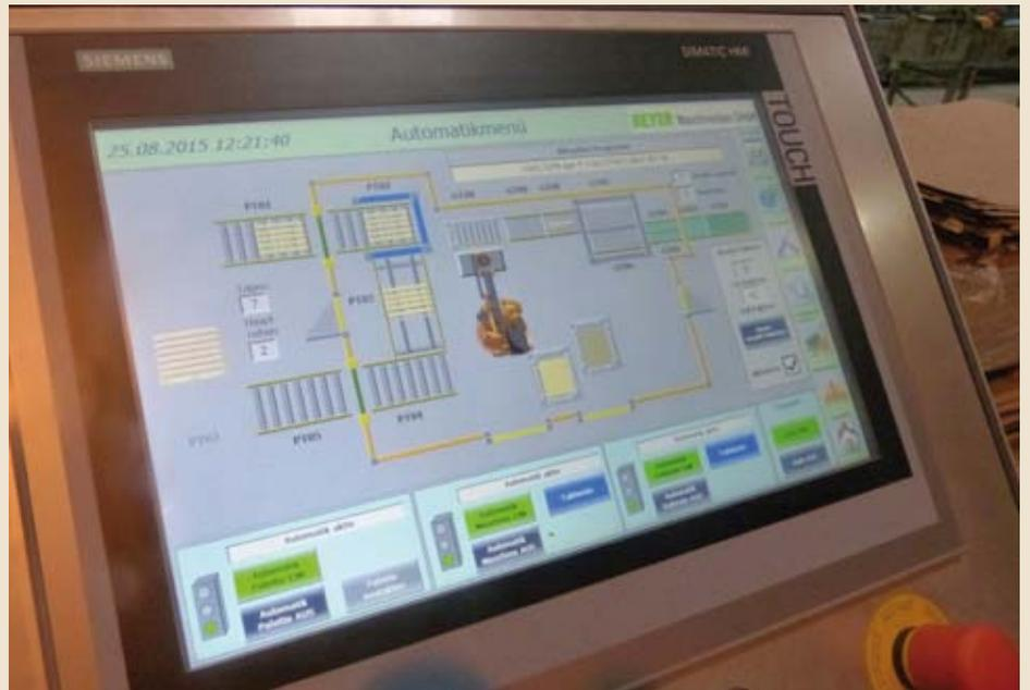
**16 Packschemata für unterschiedlichste Kundenwünsche umgesetzt per Tastendruck am Touchscreen**
